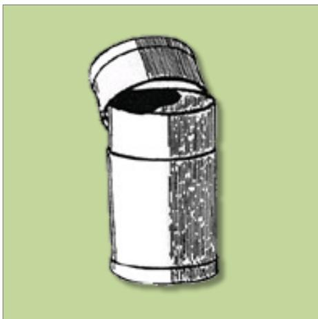
Este ejemplo se trata de un bidón de cartón, que tiene una tapadera cilíndrica envolvente. Esta tapadera se sujeta al cuerpo con cinta engomada. El peso bruto va desde los 60 Kg hasta los 200 Kg.
